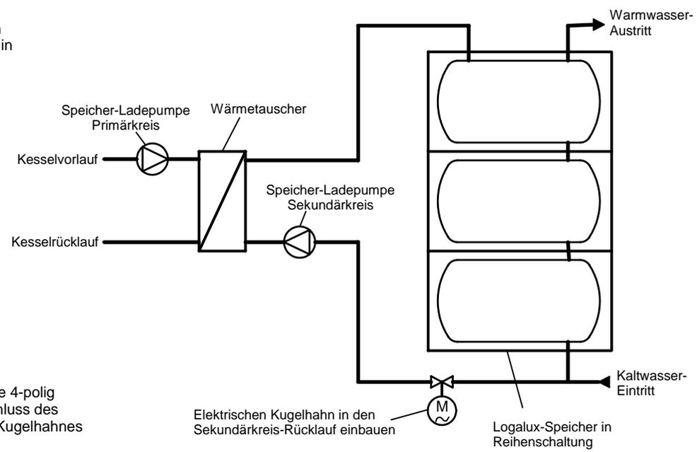
Der elektrische Kugelhahn wird geöffnet, sobald eine Wärmeanforderung von den Speichern besteht. Ist die Wärmeanforderung erreicht, schließt der Kugelhahn und verhindert eine Beimischung von kaltem Wasser in den Warmwasser-Austritt.
