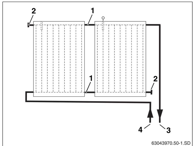
Abb. 40 Hydraulischer Anschluss - Vorlaufleitung rechts
