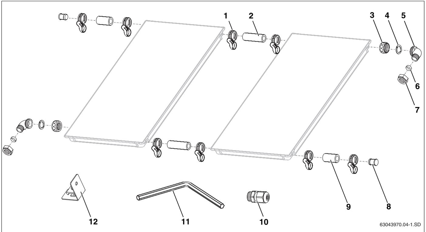
Abb. 4 Anschlusssatz und Verbindungssatz (Darstellung mit 2 senkrechten Kollektoren)
