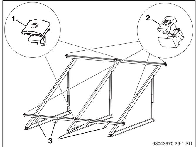
Abb. 44 Befestigungselemente für den Kollektor
