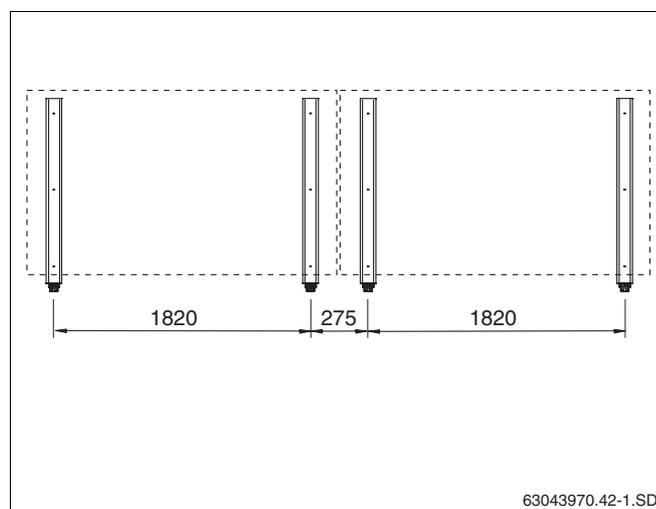
Abb. 21 Grundauführung für 2 waagerechte Kollektoren
