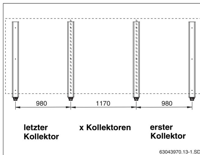
Abb. 20 Grundauführung für 3 senkrechte Kollektoren
