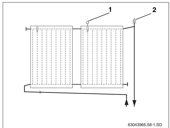
Abb. 58 Ansicht Lufttopf mit Entlüfter für Vorlaufanschluss
