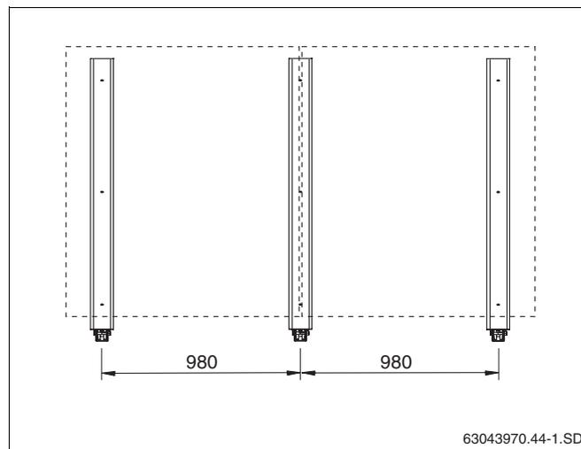
Abb. 19 Grundauführung für 2 senkrechte Kollektoren
