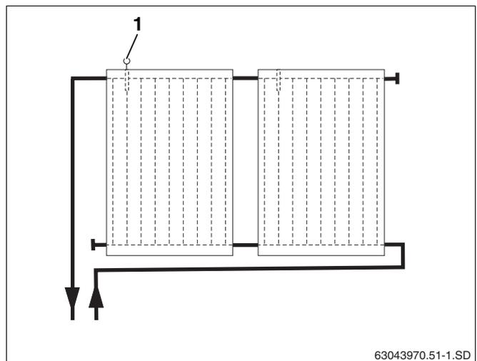
Abb. 41 Hydraulischer Anschluss - Vorlaufleitung links
