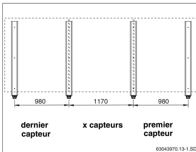
Fig. 20 Version de base pour 3 capteurs verticaux
