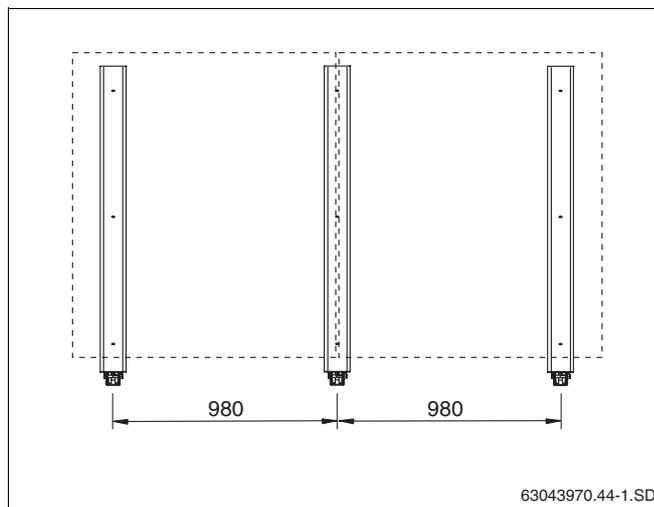
Fig. 19 Version de base pour 2 capteurs verticaux
