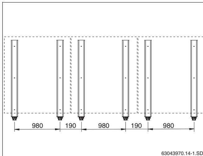
Fig. 22 Supports supplémentaires pour 3 capteurs verticaux
