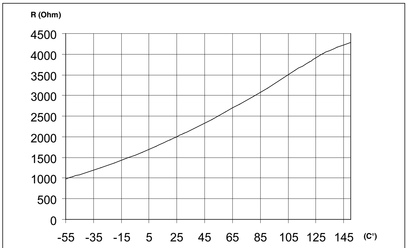
Obr. 118 Charakteristika platná pro všechna čidla teploty s výjimkou čidla teploty spalin.
