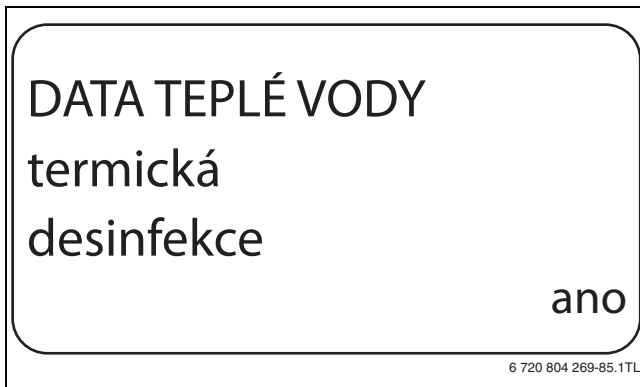
Obr. 69 Nastavení termické dezinfekce
