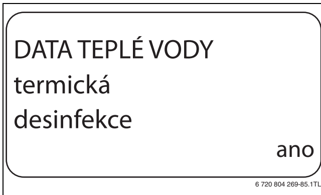
Obr. 65 Nastavení termické dezinfekce
