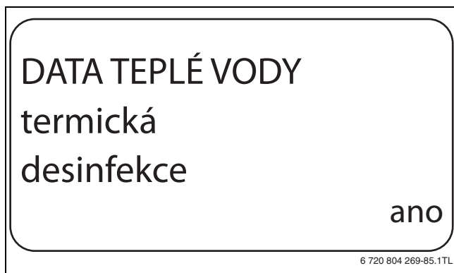
Obr. 65 Nastavení termické dezinfekce
