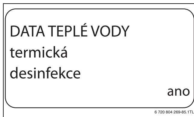
Obr. 83 Nastavení termické dezinfekce
