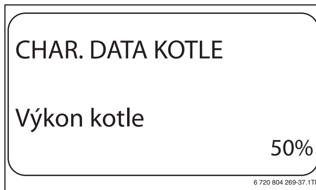
Obr. 35 Omezení výkonu kotle
