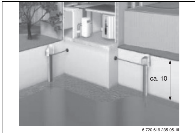
Bild 5 Grundwasserbrunnen (Maße in m)
