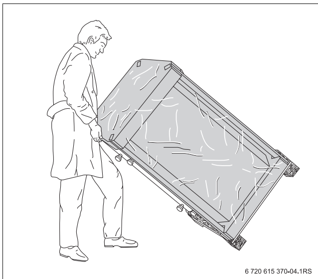
Obr. 4 Instalace zásobníku teplé vody
