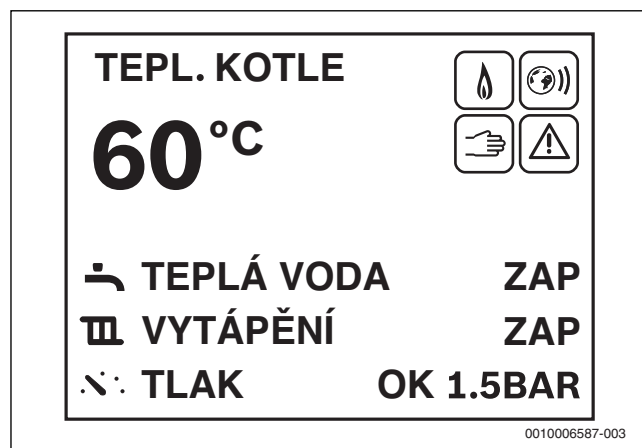
Obr. 5 Zobrazení provozního tlaku vytápění ve standardním zobrazení
