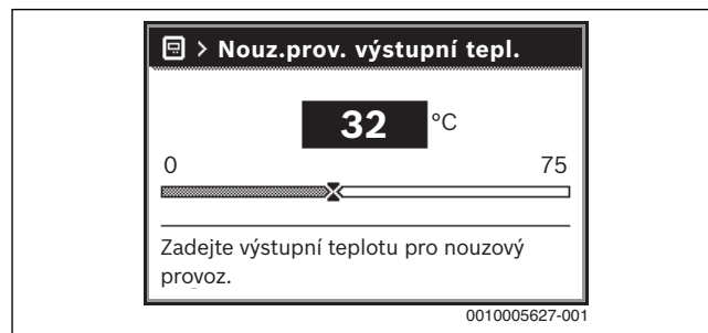
Obr. 30 Teplota na výstupu pro nouzový provoz
