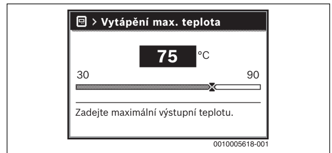
Obr. 25 Nastavení maximální teploty na výstupu
