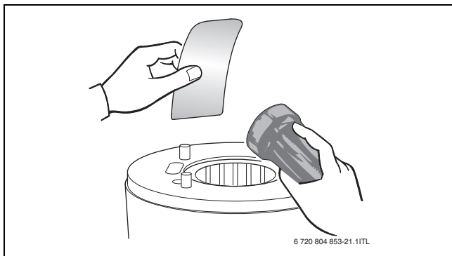
Obr. 53 Kontrola zbytků v tepelném výměníku
