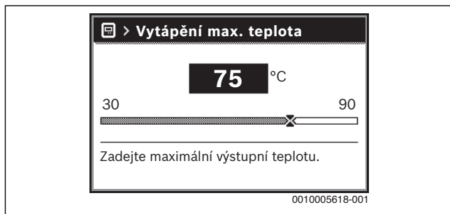
Obr. 42 Nastavení maximální teploty na výstupu
