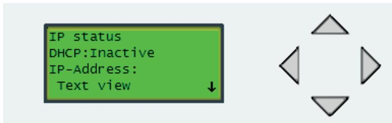
DHCP (Dynamic Host Configuration Protocol) je standardizovaný síťový protokol používaný v sítích s protokolem IP k dynamické distribuci parametrů konfigurace sítě, jako jsou IP adresy rozhraní a služeb.
