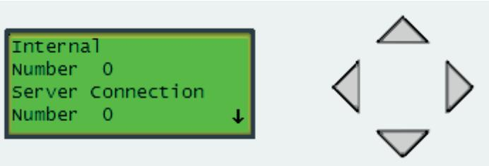
Wyświetla liczbę błędów wewnętrznych i połączenia z serwerem (patrz 4.1.1.1), brak możliwości nawigacji.
