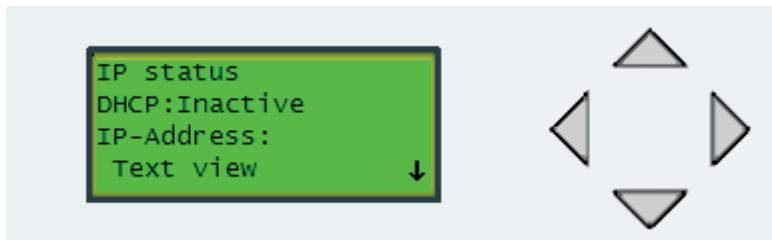
DHCP (Dynamic Host Configuration Protocol) – protokół dynamicznego konfigurowania hostów będący standardowym protokołem sieciowym używanym w sieciach IP w celu umożliwienia dynamicznej dystrybucji parametrów konfiguracji sieci, takich jak adresy IP dla interfejsów i usług.
