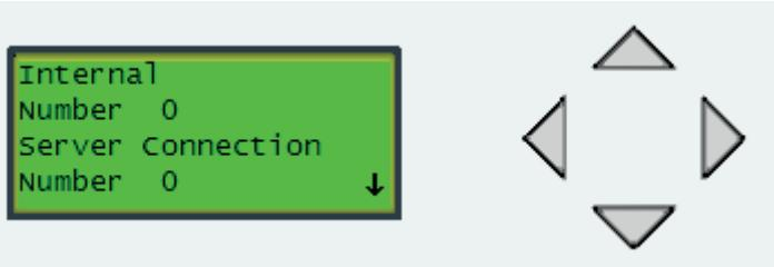
Näyttää sisäisten virheiden ja verkkoyhteysvirheiden määrän (katso 4.1.1.1.1), ei määritettävissä.
