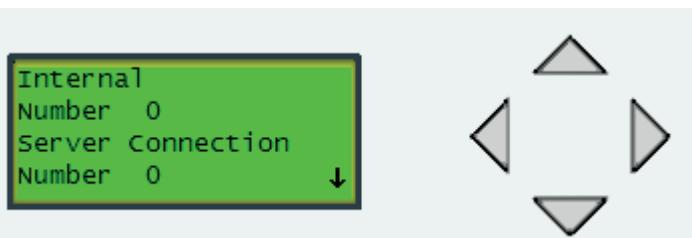
Zobrazují počet interních chyb a chyb serveru při připojování (viz 4.1.1.1), nelze měnit.
