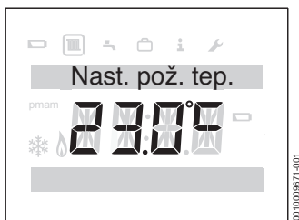
Obr. 11 Požadovaná hodnota teploty prostoru
