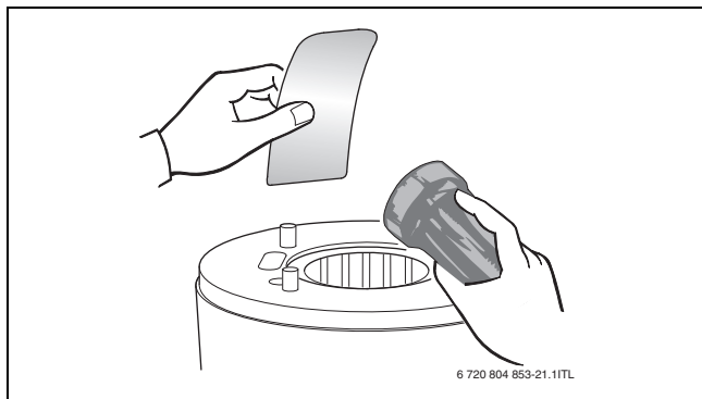
Obr. 55 Kontrola zbytků v tepelném výměníku
