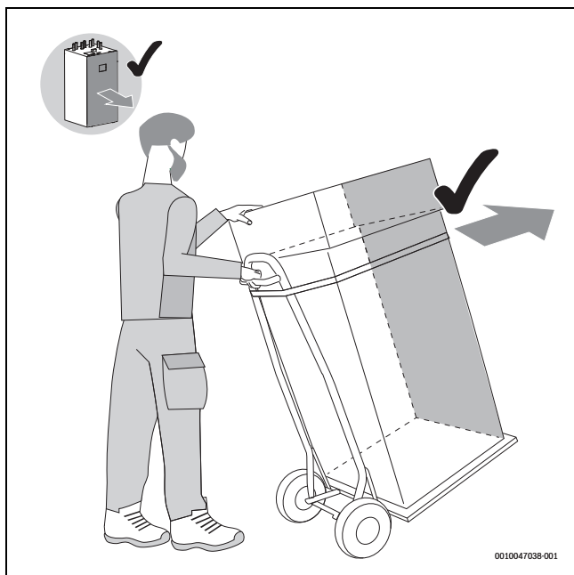
Obr. 9 Přeprava vnitřní jednotky pomocí rudlu
